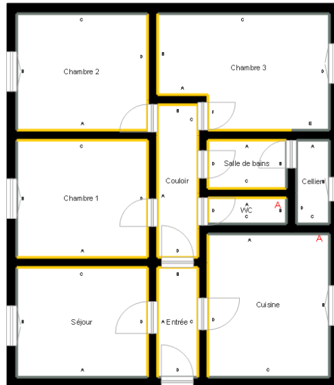
A =Conduit amiante
